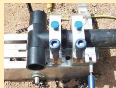
Hàn phụ kiện đối đầu - Face to face Welding Method
